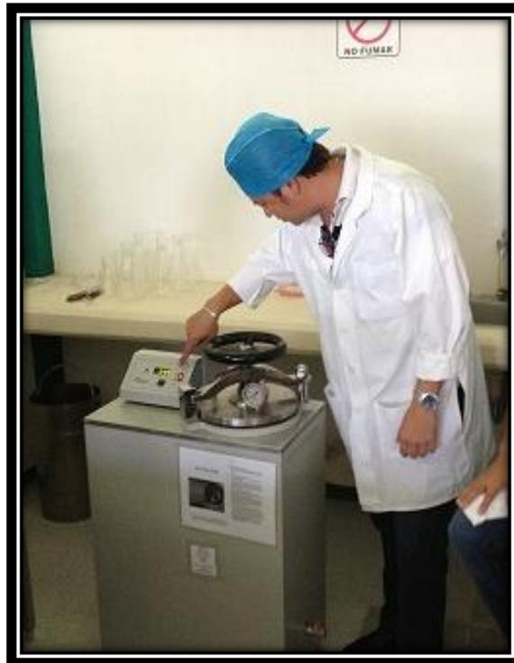
Figura 2. Esterilización del medio de cultivo en autoclave.
