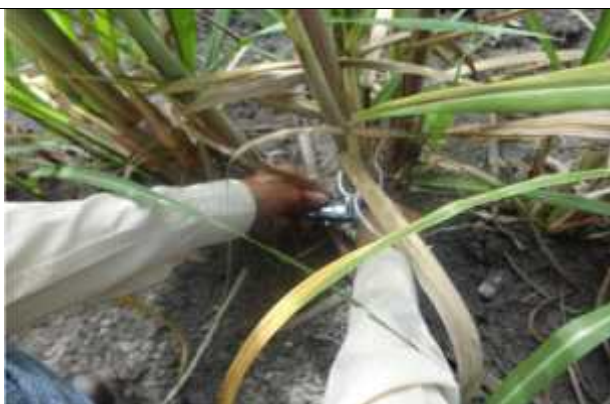
Foto 23. Toma del diametro de la planta, se coloco el vernier en la base de la caña para la toma de datos, presionando con este la parte mas delgada de la base.
