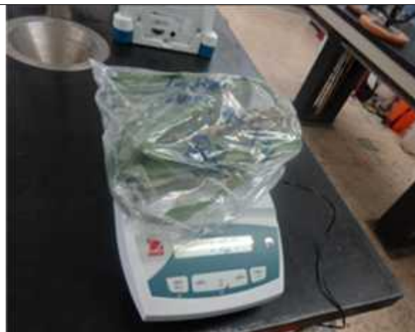
Foto 22. Equipo para tomar el peso de la biomasa de la caña (se utilizo a los 90 y 120 DDS).
