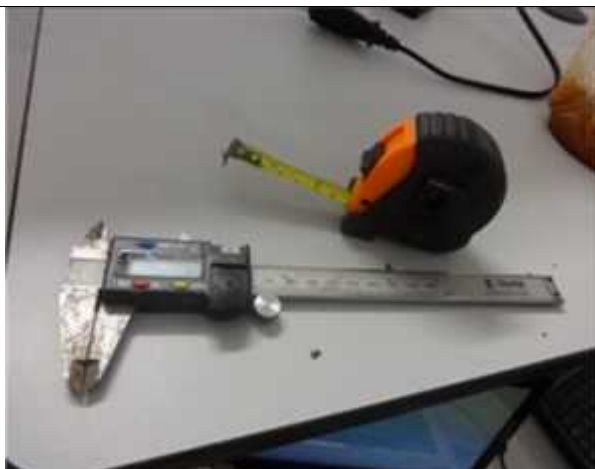
Foto 21. Herramientas utilizadas para la toma de datos (vernier y flexometro), ATO (cm), ATC (cm), DMT (mm), a los 90 y 120 DDS.
