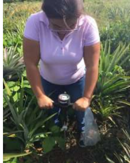
B) VERIFICACIÓN DE COMPACTACIÓN PENETROMETRO.
