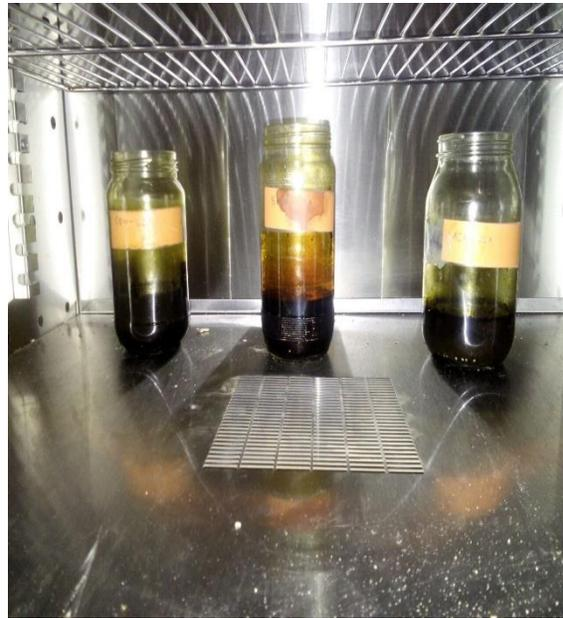
Proceso de secado del extracto puro en estufa eléctrica a 45°
