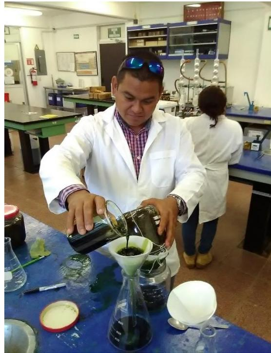
Extracto obtenido mediante ultrasonido listo para pasar a roto evaporador
