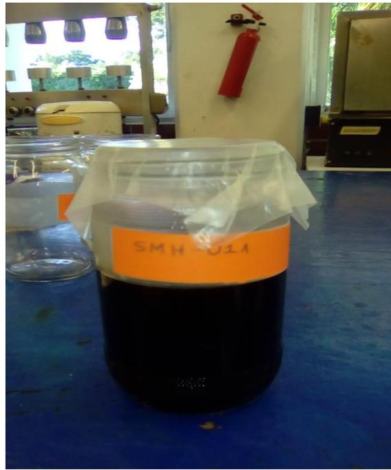
Extracto puro obtenido mediante rotoevaporador
