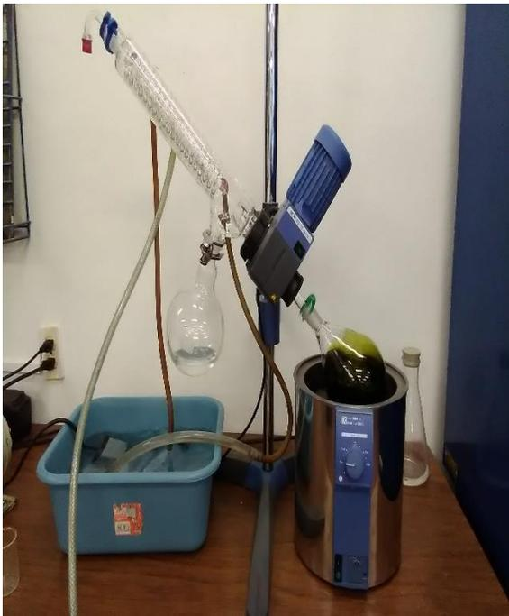
Proceso en rotoevaporador para separación del disolvente
