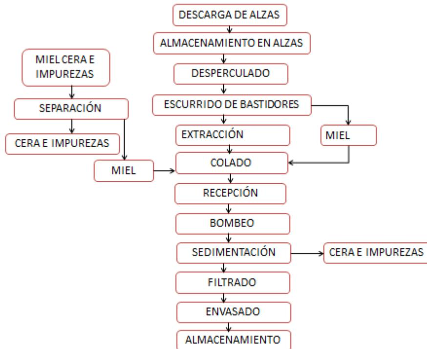
**Figura 22 Proceso de Extracción y Envasado de la Miel en la empresa**
