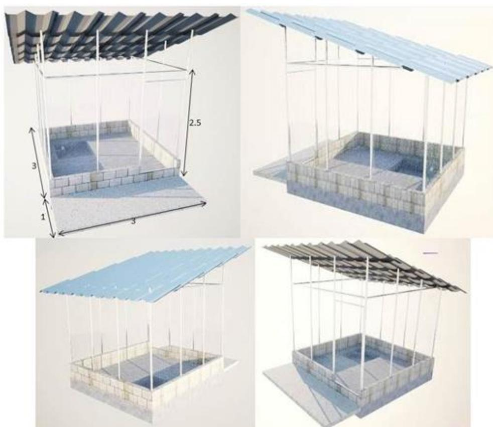
**Figura 21. Descripción de las instalaciones indicando medidas y tipo de materiales.**
