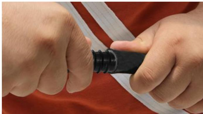
Figura 51.- Conexión manguera hidráulica a la cinta de riego
