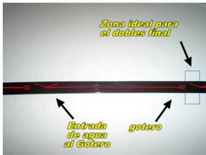
Figura 55.- Ultimo dobles se debe de realizar en el espacio que hay entre el último gotero
