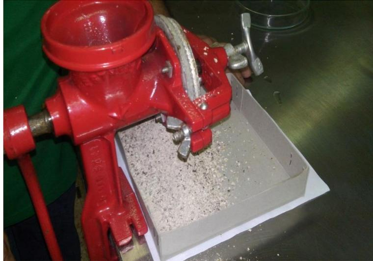
**Figura 5.** Proceso de molienda de semillas de ramón.
