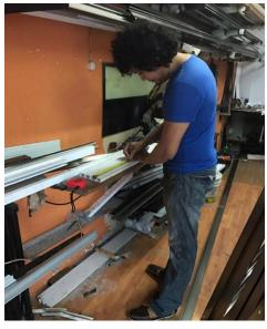
**Trazado.** Se procede a un trazado de los pedazos de P.V.C con lo cual se dibuja sobre los pedazos la forma exacta que tendrá cada pedazo de P.V.C delineando de manera exacta el contorno de cada pedazo, buscando que los rectángulos de cada corte sean similares a los otros pedazos de las mismas medidas, posterior mente poder pasar al corte.
