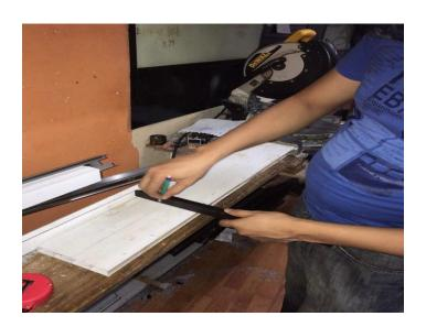
**Cortado.** Se procede cortar cada pedazo de retacería de P.V.C con los trazos realizados en ellos previamente medidos y trazados con lo cual se tendrán los pedazos ya en forma y con las medidas adecuadas, el corte tiene que ser lo más preciso y fino para que puedan unirse cada pedazo de forma perfecta, para proceder a ensamblarlos.
