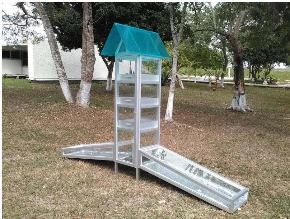
Figura 10. Deshidratador solar instalado.
