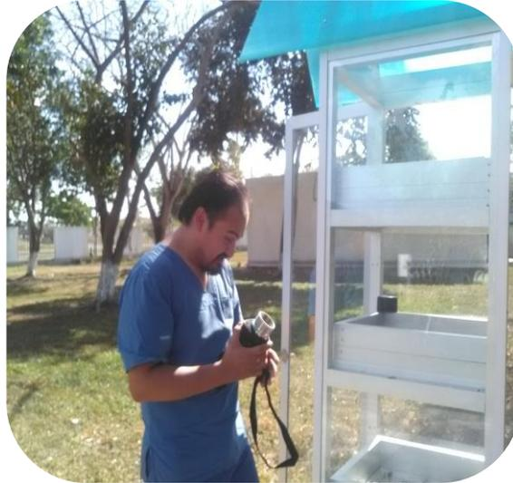
Figura 19. Tomando la humedad de las semillas con el medidor de humedad para grano.
