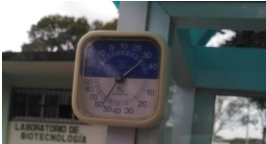
Figura 17. Termómetro higrómetro analógico.
